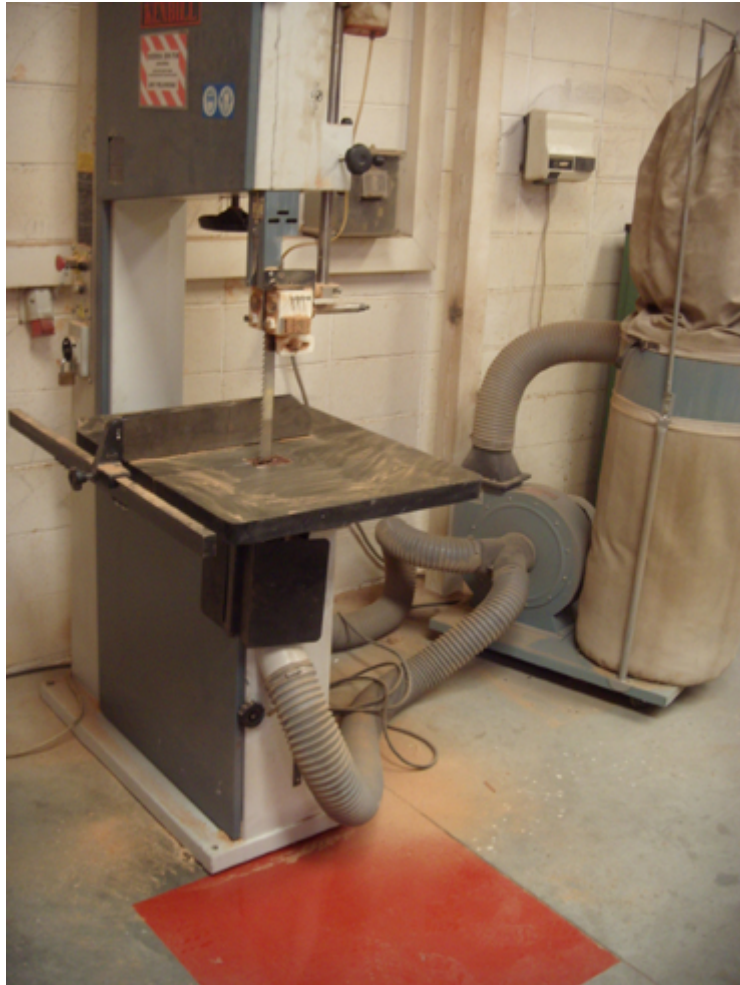
Figura 7. Sierra de cinta para madera, debidamente señalizada. Resulta extremadamente peligrosa, de manera que queda restringido su uso sólo para personal cualificado.
